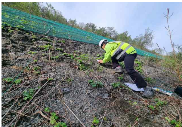
절리면 경사/경사방향 측정
